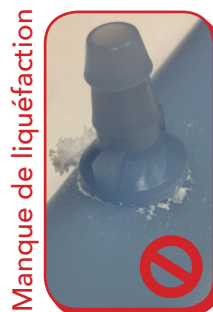
Manque de soudure
