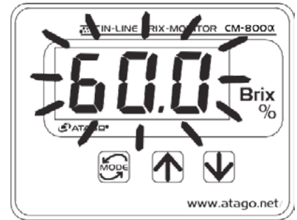
Figure 14-4 Exemple lorsque la limite supérieure de la gamme de sorties de l'enregistreur est réglée à un % Brix de 60,0 %.
