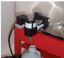
Valve d'embouteillage électrique. Inclus 3 embouts en acier inoxydable : 1/4", 3/8", 1/2" 67217
