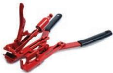
Pince de réparation avec tension automatique et évaseur 6623160
