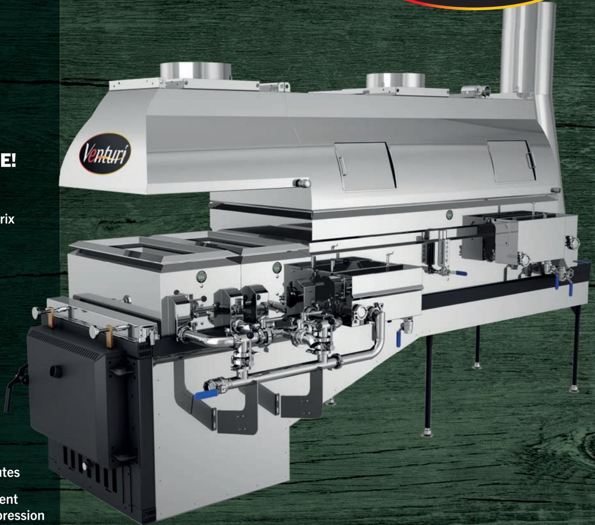
La gamme d'évaporateurs **Venturi haute performance airtight CDL** possède un **système de tire artificiel** unique permettant **l'apport d'air primaire à haute pression par succion**. Augmentez de façon simple et sécuritaire la performance d'évaporation de l'évaporateur avec le système Venturi Performance développé par CDL.
